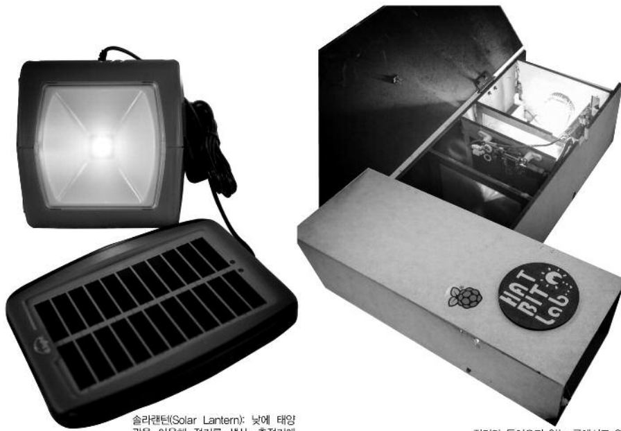
전기가 들어오지 않는 곳에서도 영화를 볼 수 있는 '햇빛 영화관', 태양광 전력을 이용, 이동이 용이해 오지에서도 운반, 설치 가능하다.
